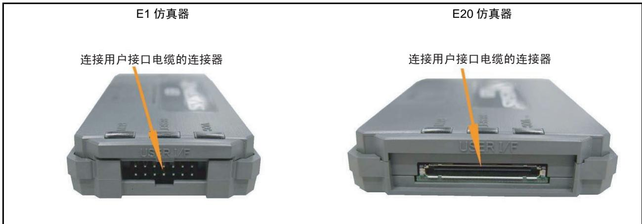
图 2.2 E1/E20 仿真器的用户接口电缆连接器的配置
