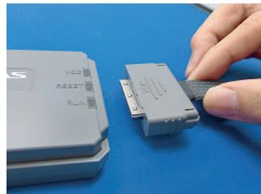
1. 请将用于连接用户接口电缆的仿真器连接器安装到用户系统上。推荐的连接器如表2.1所示。
